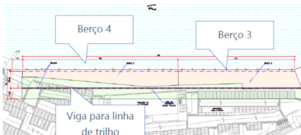
Figura 21 – Localização da viga para linha de trilho STS Fonte: Consórcio Demarest
