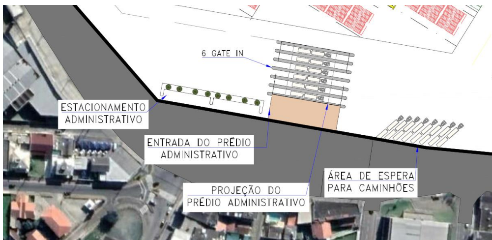
Figura 38 – Gate e novo prédio administrativo Fonte: Elaboração própria
